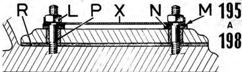
197 - Montage du couvercle supérieur Installing the upper Cover Aufsetzung des oberen Deckels Montaje de la tapa superior
