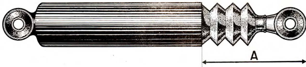
68 - Vérification des amortisseurs télescopiques avant — Checking Front Telescopic Shock Absorbers Prüfen der vorderen Teleskop-Stossdämpfer — Comprobación de los amortiguadores telescópicos delanteros
