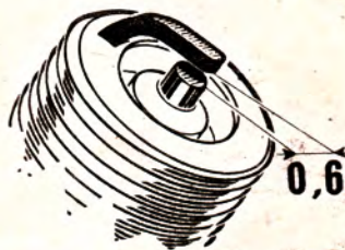
3 - Réglage des bougies Spark plug gap adjustment Zündkerzen-einstellung Regulacion de las bujias
