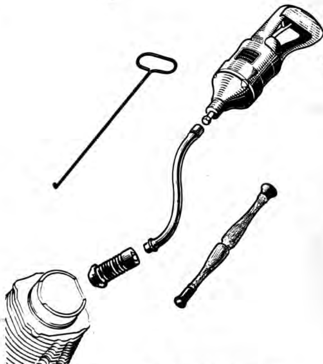
149 - Outillage pour rodage des sièges et des soupapes Valve and seat grinding tool Werkzeug zum Einschleifen der Ventile und Ventilsitze Utilaje para rodadura de los asientos y de las válvulas
