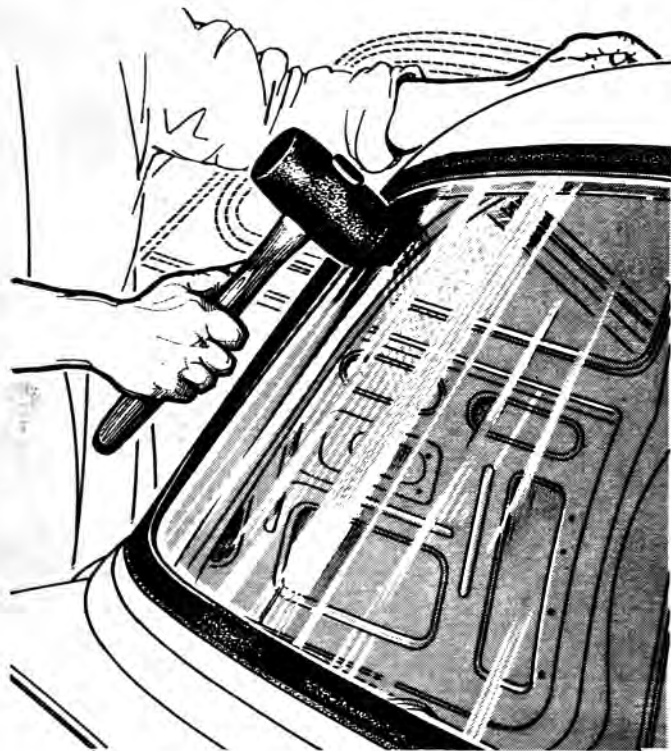
313 - Finition du montage du pare-brise Seating the weatherstrip Fertigung der Einsetzung der Windschutzscheibe Acabado del montaje del parabrisas
